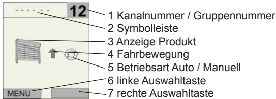
Abb. 1 Display im Betriebsmodus (Beispiel 1): Kanal 12, eingelernte Jalousie, Automatik aktiv, Fahrbewegung AUF
