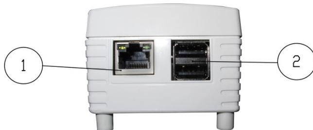
Abbildung 1: BiEasy Box Anschlussmöglichkeiten (Seitenansicht)
