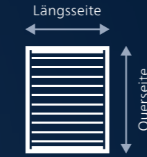
Längsseite = Lamellen hintereinander Querseite = Lamellen nebeneinander
