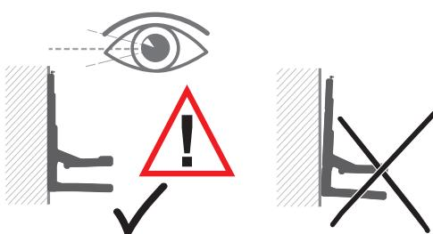
Prüfen Sie regelmäßig (1x jährlich) die Befestigung auf festem Sitz im Mauerwerk (Sichtprüfung durch Rütteln an der Anlage).
