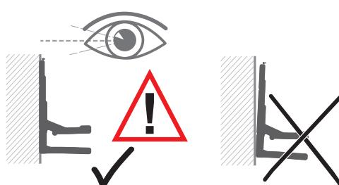
Vérifiez régulièrement (1 fois par an) si la fixation est bien logée dans la maçonnerie (contrôle visuel en secouant l'installation).
