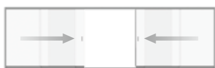
Systeem met tussenstijl – naar twee zijden te openen, sluit in het midden
